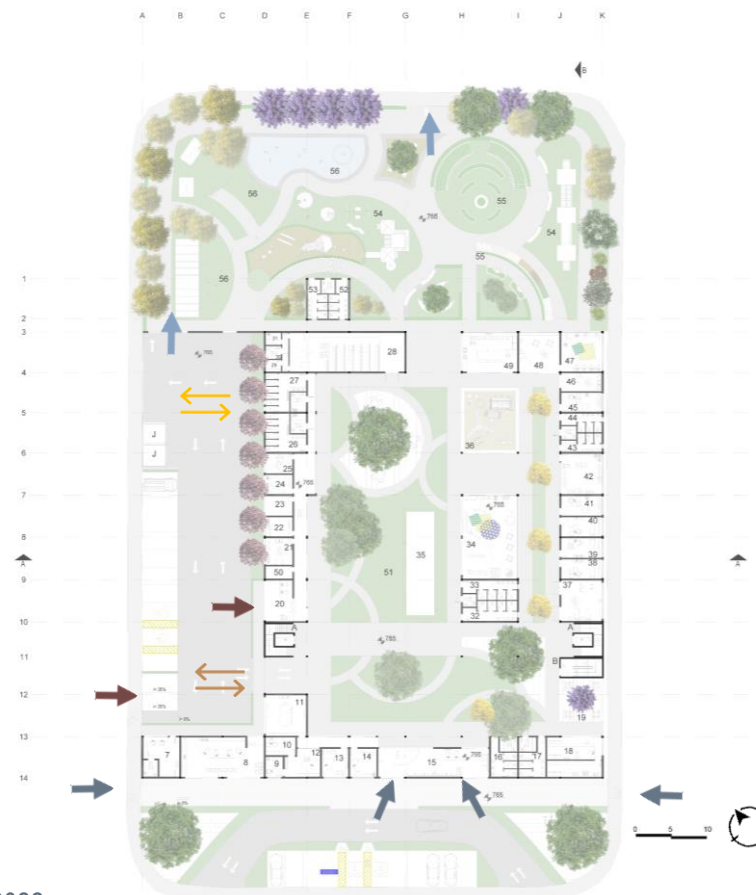
Figura 18: Planta ambientes pavimento térreo
