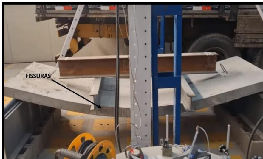
Figura 14 – Ensaio com laje armada com Vergalhão de Fibra de Vidro – Situação com a aplicação da carga
