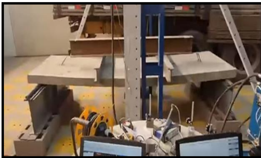
Figura 15 – Ensaio com laje armada com Vergalhão de Fibra de Vidro – Situação com alívio da carga
