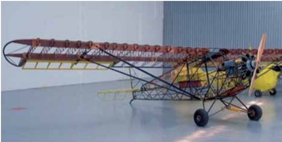
Figura 1.15 – Estrutura tubular sem o revestimento de tela
