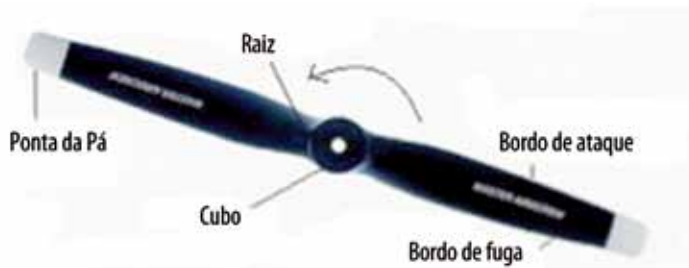
Figura 2.19 – Características geométricas de uma hélice
