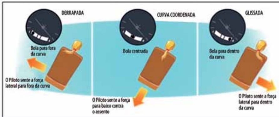
Figura 3.17 – Indicador de Curva. Três situações de uma curva a direita
