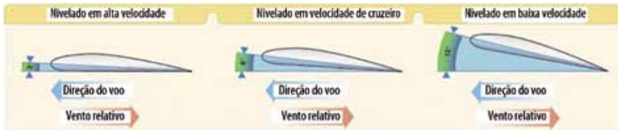
Figura 1.12 – Variação do ângulo de ataque em função da velocidade
