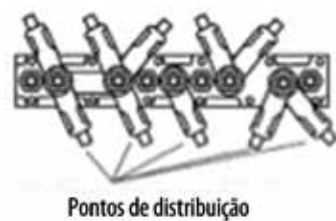
Figura 2.23 – Barra elétrica ou barramento
