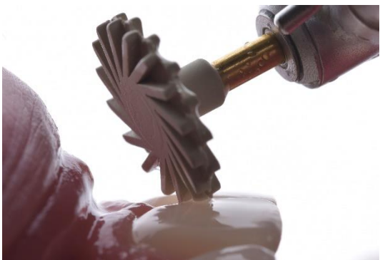
Figura 9 -Disco de borracha diamantada- granulação fina.
