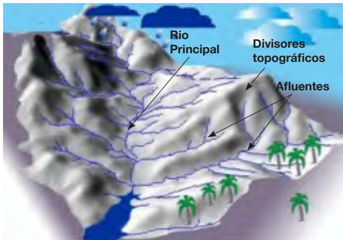
Figura 2.5 – Representação esquemática de uma bacia hidrográfica
