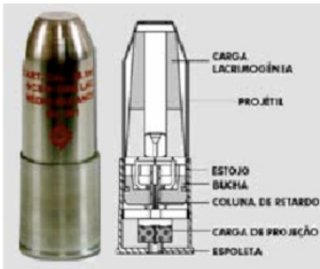
Figura 6.25 – Cartucho calibre 38,1 com carga lacrimogênea Fonte: Senasp (2007).
