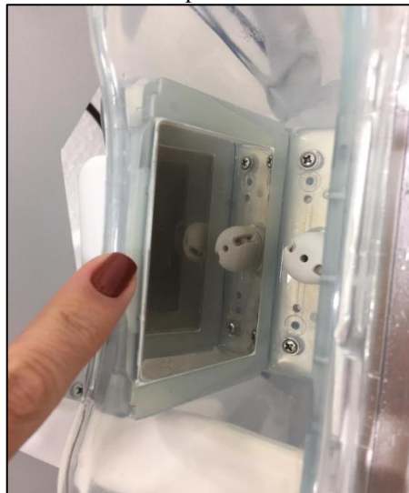
Figura 3 - Posição da placa de Peltier dentro do manípulo tamanho médio
