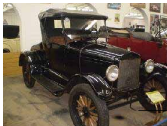
Figura 2.15 – Automóvel Ford 1920 com partida a manivela
