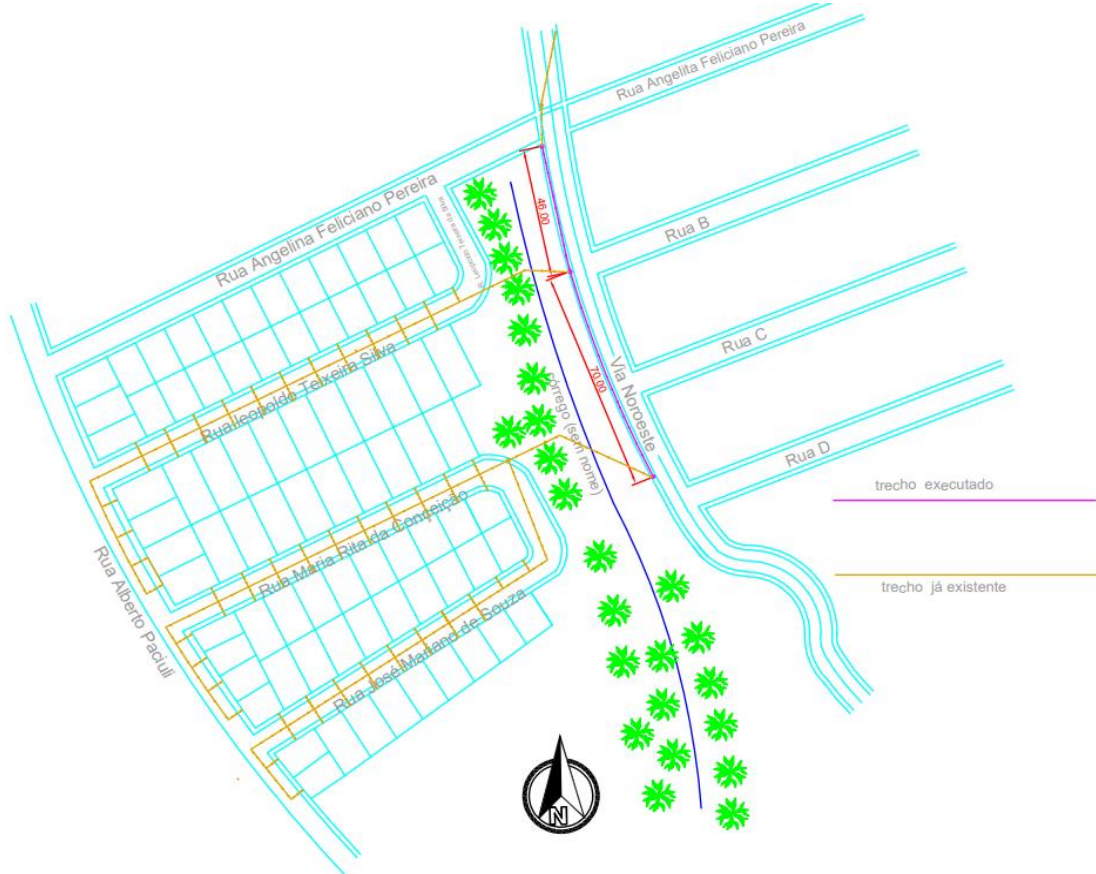
Figura 3 – Projeto da rede coletora de Esgoto Sanitário
