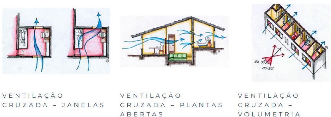
Figura 10- Exemplos de ventilação passiva.
