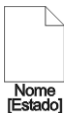
Figura 16: Exemplo de Objeto de Dados. Fonte: Adaptado de BPMN (2005)
