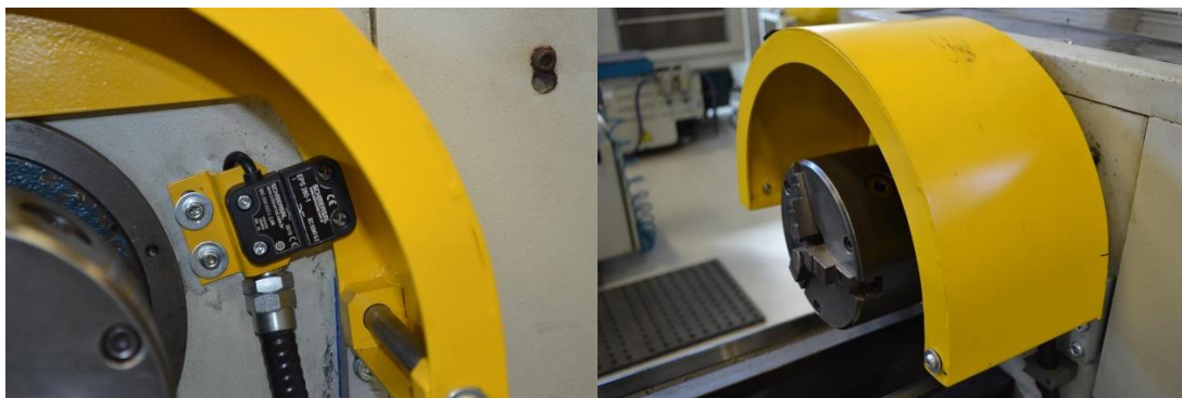
Figura 4 - Exemplo de dispositivo de intertravamento
