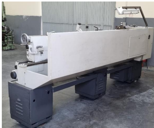
Figura 5 - Exemplo de proteção fixa contra cavacos e respingos
