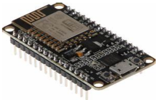
Figura 7 : Módulo ESP8266 Node MCU
